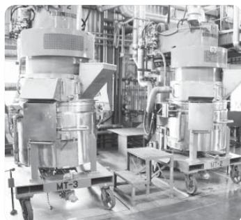
大きな攪拌機（塗料を混ぜる機械）で、原料を混ぜ合わせます。
