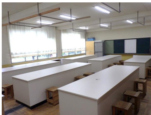
元々、教材室(旧理科室)であった教室を図工室に更新。理科室用の机を図工室用の机に改修し、照明も LED に。
